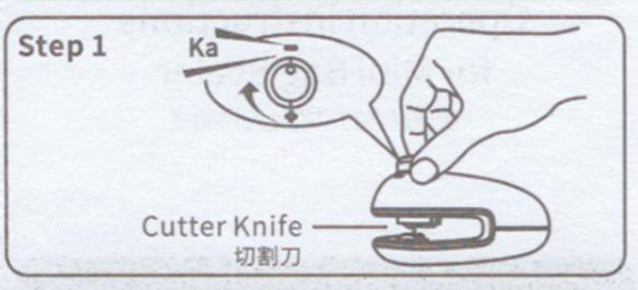
Press the blade button and glide. 下压刀口按钮滑动。
